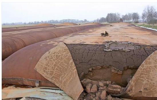
In solchen Säcken, Geotubes genannt, wird Ockerschlämme entwässert und wie hier an der Ragower Kahnfahrt gelagert. Ziel ist eine Verwertung oder Deponierung.
